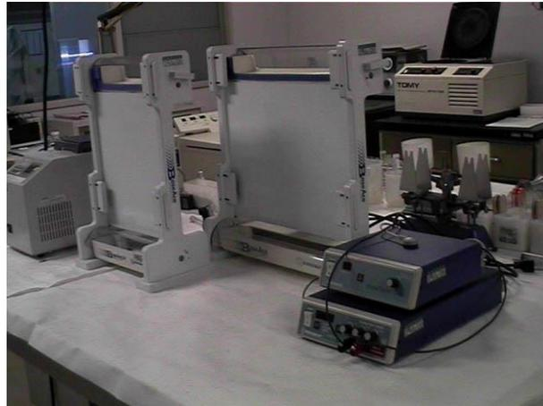
SSCP ゲル電気泳動装置 ストラタジーン
