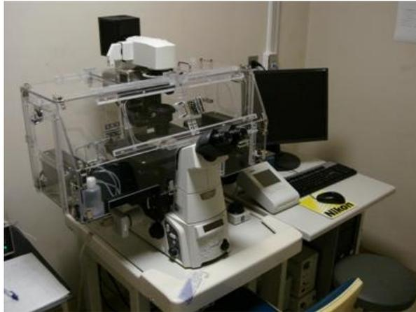
蛍光倒立電動顕微鏡 Ti-E
