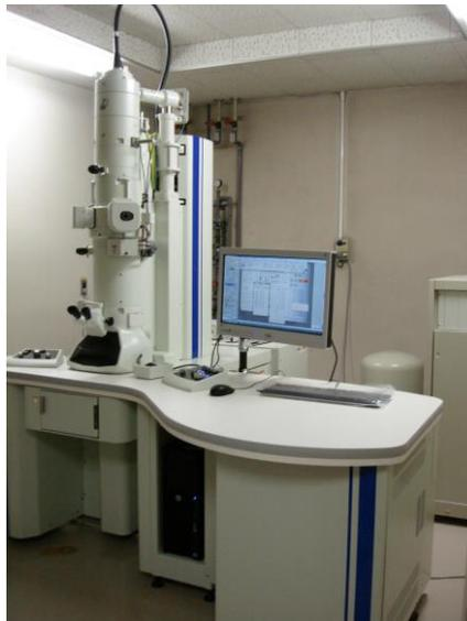
透過型デジタルカメラ搭載電子顕微鏡 JEM-1400Plus
