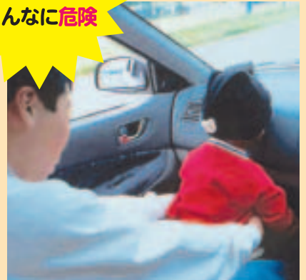
時速30kmの急ブレーキでとび出す「抱っこ」の子ども（JAFユーザーテストより）
