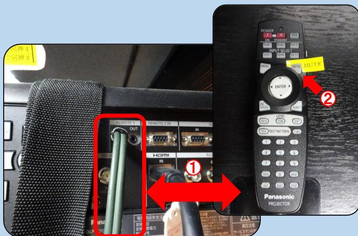
① プロジェクタとリモコンをリモコンケーブルで接続します。
